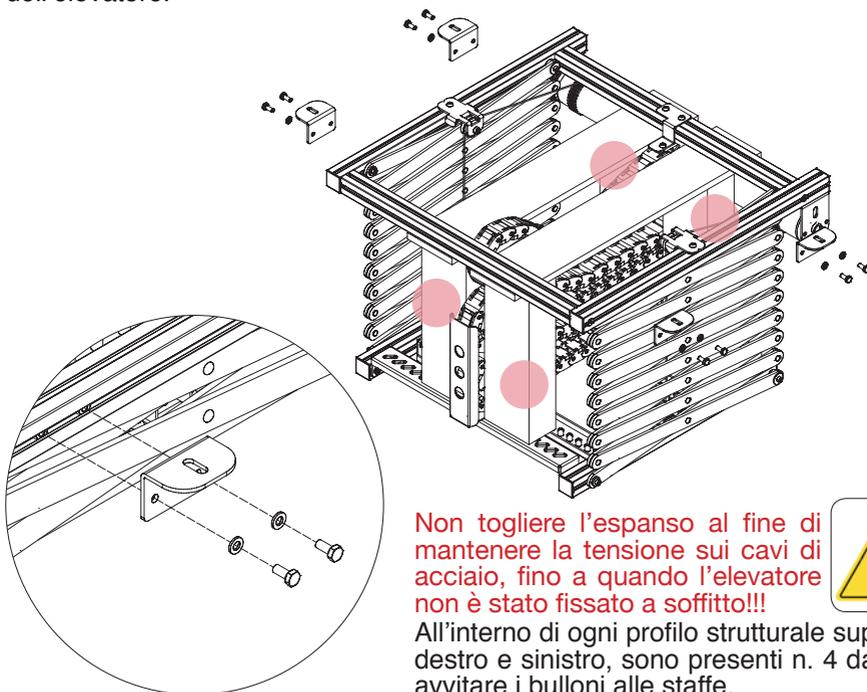
Il disegno sotto, descrive la posizione consigliata di montaggio delle staffe a "L". Nella presente guida per il montaggio, si considera un'installazione ad un soffitto piano ed in cemento armato.
