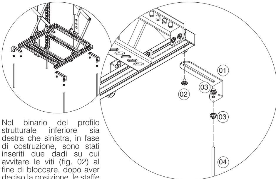
Nel binario del profilo strutturale inferiore sia destra che sinistra, in fase di costruzione, sono stati inseriti due dadi su cui avvitare le viti (fig. 02) al fine di bloccare, dopo aver deciso la posizione, le staffe scorrevoli (fig. 01).
