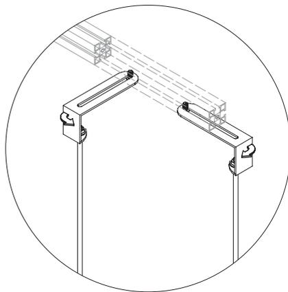
Dopo aver fissato le barre filettate (fig. 04), decisa la loro lunghezza, è possibile fissare il pannello del controsoffitto utilizzando due tipi di viti.
