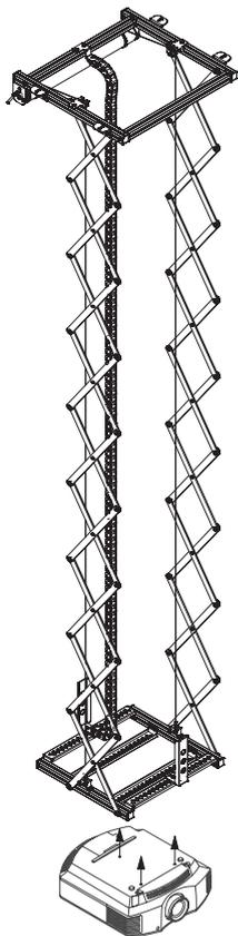
E' importante disporre in modo corretto il proiettore evitando che forze di ribaltamento avverse possano agire in modo non uniforme sul meccanismo di apertura e chiusura.
