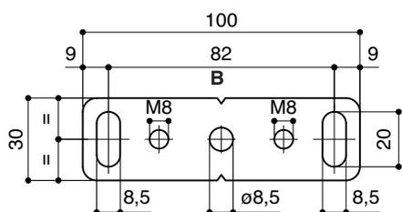
SCHEMA ANCORAGGIO A SOFFITTO
