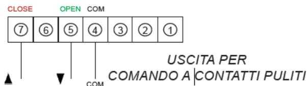
**Collegamento Uscita per gestione comando altre utenze a contatti puliti:** Utile per la gestione di comando di altre utenze o apparecchiature. I contatti comando sono PRIVI di tensione. Collegare il filo del COMUNE al morsetto 4, il filo APRE con il morsetto 5 e il filo CHIUDE con il morsetto 7.
