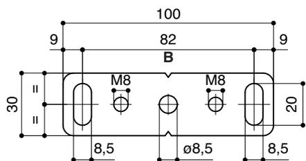
SCHEMA ANCORAGGIO A SOFFITTO
